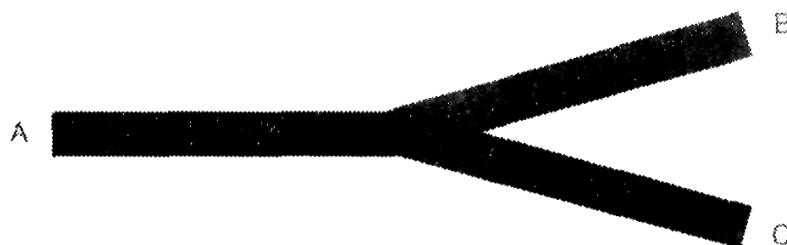
Рис. 3.10. Y-переход или разветвитель 1×2. (С разрешения компании Australian Photonics CRC, взято из Интернет [3.5])
