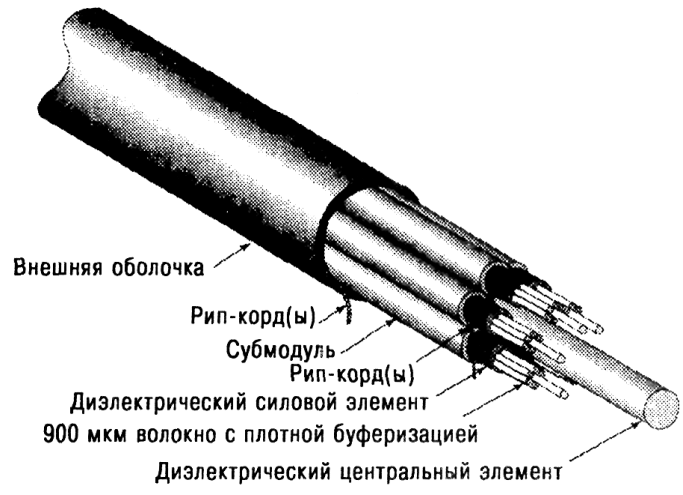
Рис. 2.7(б). Поперечные сечения скрутки и конструкция кабелей с плотной буферизацией компании Corning Cable Systems для использования внутри зданий. Это пожаробезопасные (с замедленным распространением горения) кабели, удовлетворяющие требованиям кодов NEC (магистральные кабели типа Unitized MIC) (с разрешения компании Corning Cable Systems, LANscape Solution Catalog, с. 1.30 [2.7]).
