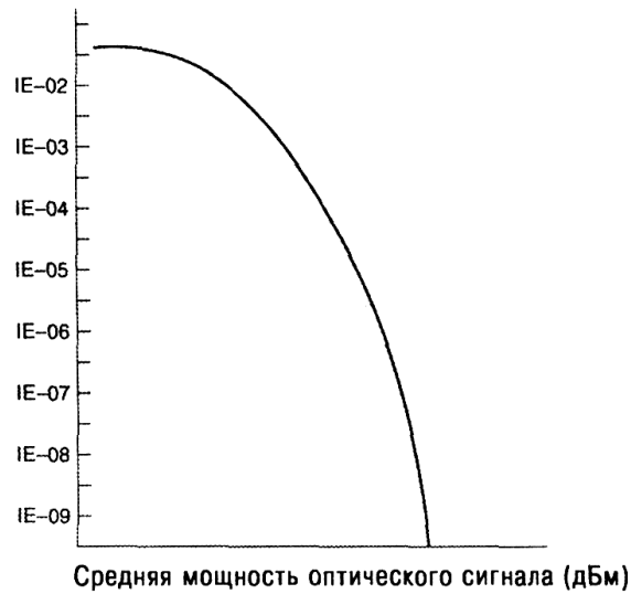
Рис. 5.10. Кривая с траекторией «водопада» отображает зависимость BER от уровня принятой мощности.
